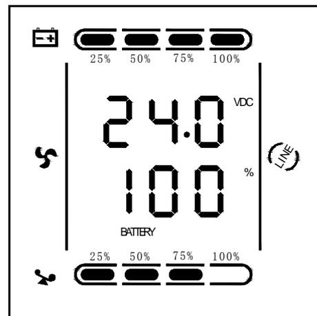
Mantenga presionada la tecla ◀ por más de 2 segundos, la pantalla LCD empieza a mostrar los elementos que la transferencia circularmente y ordenado a otro cada 2 segundos. Mantenga pulsada la tecla ◀ durante 30 segundos, regresará al estado de salida.
